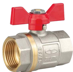
Zawór kulowy wodny z dławikiem W-W z motylkiem
