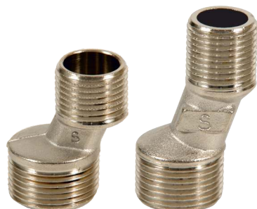
Krzywka do baterii 1/2" × 3/4" mimośród 11 mm
