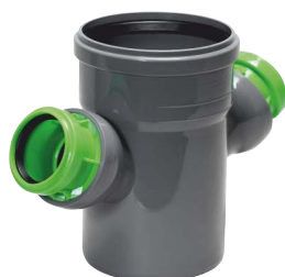
Czwórnik nastawny ø110/ø50/ø110/ø50 kąt regulowany 45-88°
