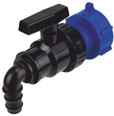
Zawór czerpalny 1" z redukcją S60 x 6 do zbiorników na deszczówkę typu IBC (Mauzer)
