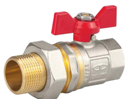
Zawór kulowy wodny z dławikiem z półrubunkiem z motylkiem
